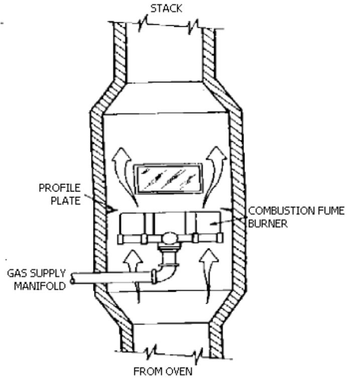
**DUCT TYPE FUME BURNER**
