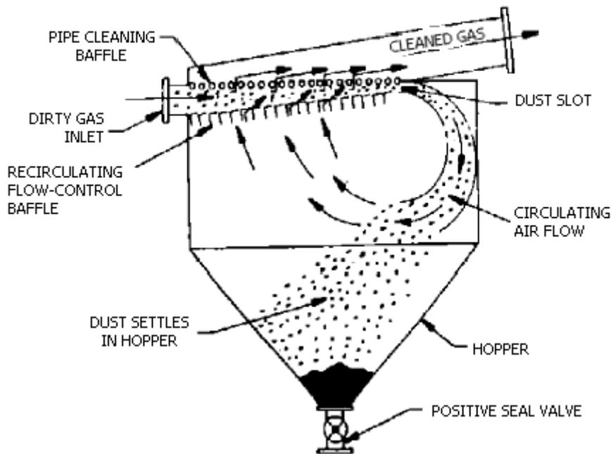
**RECIRCULATING BAFFLE COLLECTOR**
