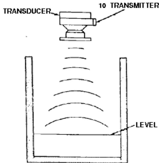
**TOP MOUNTED ULTRASONIC-TYPE LEVEL TRANSMITTER**
