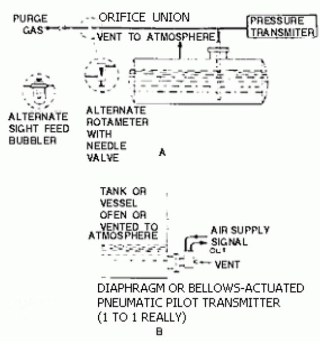
**HYDROSTATIC HEAD LEVEL TRANSMITTERS**
