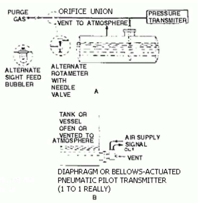
**HYDROSTATIC HEAD LEVEL TRANSMITTERS**
