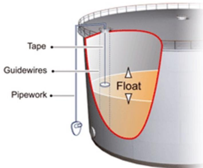
**GROUND READING TANK LEVEL INDICATOR**
