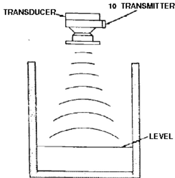
TOP MOUNTED ULTRASONIC-TYPE LEVEL TRANSMITTER
