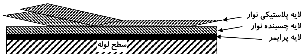
شکل ۱۷- جدا شدن قسمتی از لایه چسب نوار با لایه محافظ از روی سطح لوله پرایمر خورده
